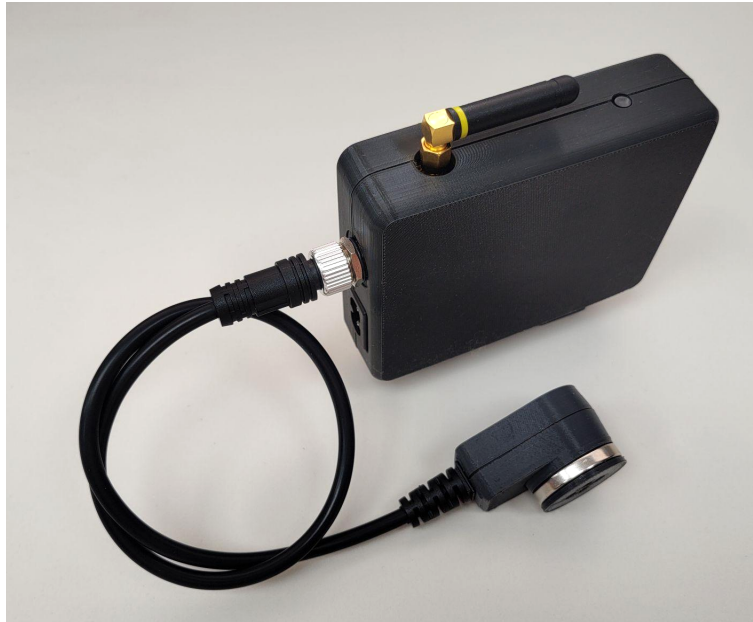
Figura 1 - Captor óptico y módulo LoRa desarrollado por Redimec SA
