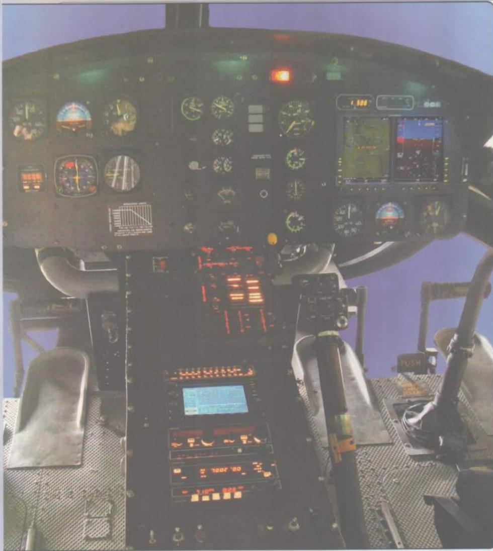
Un Stormscope WX-500 cuyo procesador está montado en el compartimiento de electrónica y comunicaciones en la parte trasera izquierda del helicóptero. La imagen provista por el procesador es mostrada en el GDU 620 y en el GNS 530AW. El procesador stormscope es controlado desde el GNS 530AW. Este sistema provee excelente información táctica a los tripulantes para la toma de decisiones en condiciones meteorológicas adversas hasta 200 millas náuticas y 360 grados.
